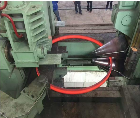
上抽式数控辗环机 Upper extracting ring rolling machine
