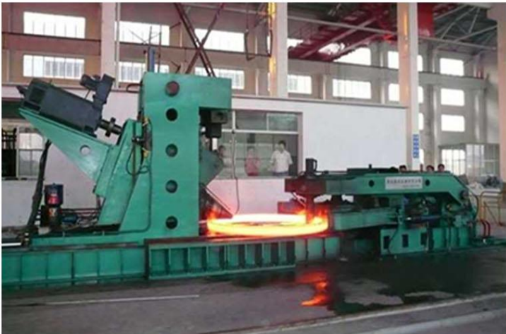
上盖式数控辗环机 Top covering ring rolling machine
